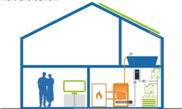
Abbildung 4: AC•THOR im AC Inselnetz
