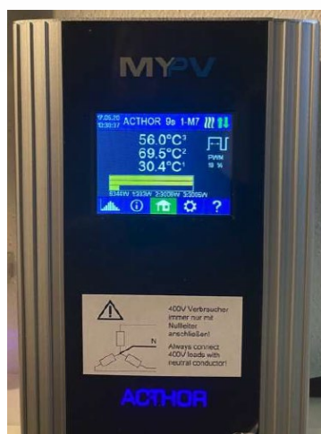
Der AC•THOR 9s erhält das Steuersignal direkt vom Kostal Smart Energy Meter über das Netzwerk.
